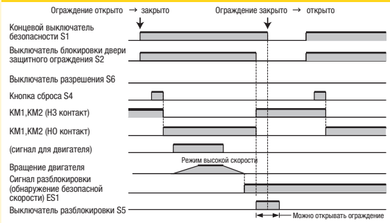
Временная диаграмма режима обслуживания (M1: ВЫКЛ, M2: ВКЛ)
