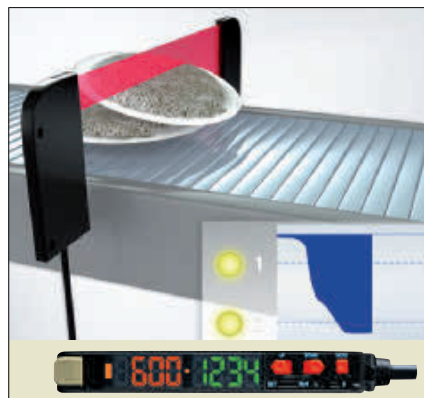
Два выхода усилителя можно использовать для распознавания двух отличающихся уровней яркости.
