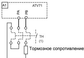
В преобразователях мощностью до 160 кВт (ATV71HC16N4) тормозные сопротивления подключаются непосредственно к клеммнику ПЧ, расположенному внизу (клеммы PA и PB).
