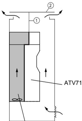
Вентиляционный канал охлаждения силовых элементов.
