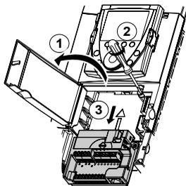
1 Для доступа к клеммникам цепей управления откройте крышку лицевой панели управляющей части ПЧ
