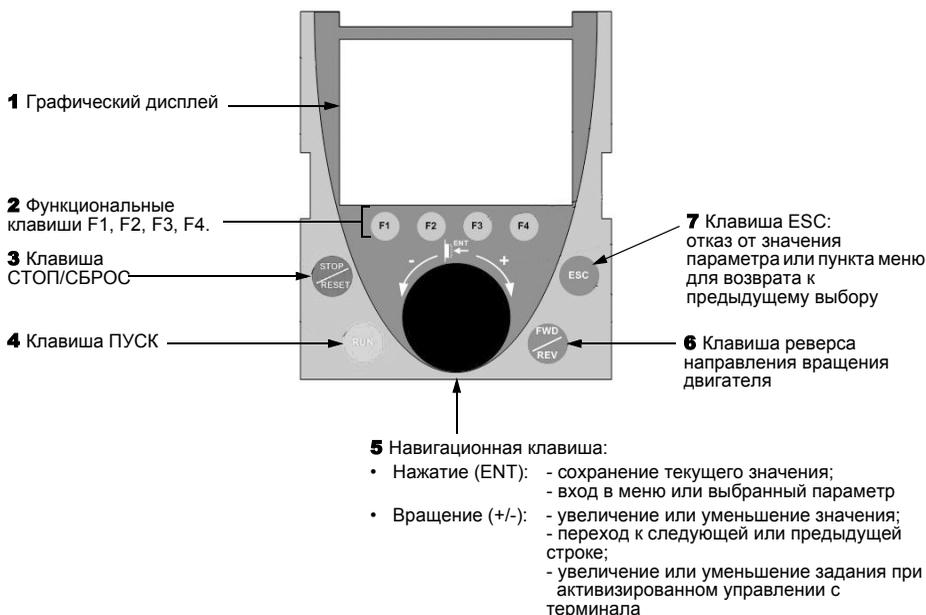
**Примечание:** клавиши 3, 4, 5 и 6 обеспечивают непосредственное управление преобразователем при активизированном управлении с терминала.
